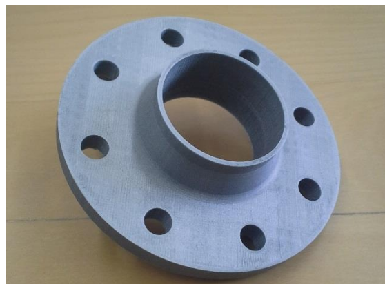
Im Rahmen des Projekts wurden die Möglichkeiten zum Druck von Modellen getestet, hier ein V-Flansch
