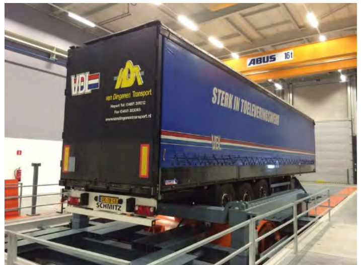
Auf dem neuen Prüfstand mit High-Torque-Technologie können Großfahrzeuge wie Busse und LKWs getestet werden
