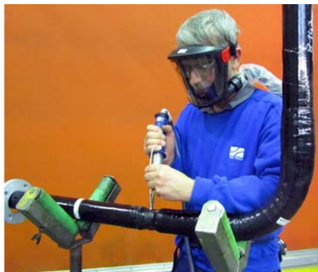
Tectrion-Mitarbeiter beim Warmgasziehschweißen an einer PTFE-M/GFK-el Rohrleitung DN50 Quelle: TECTRION GmbH
